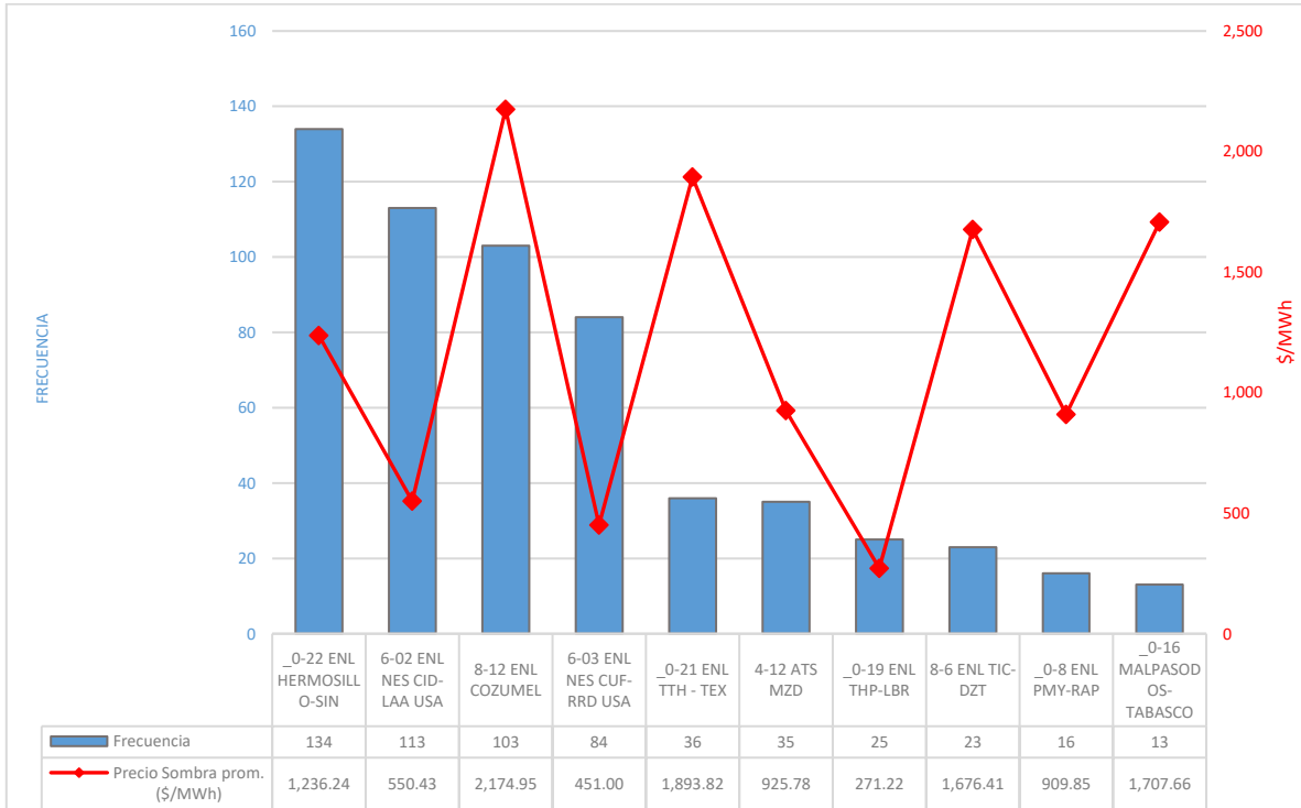
Figura 9a. Frecuencia de Enlaces de Transmisión Congestionados en el MDA.
